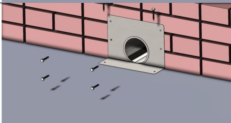
3. Закрепить на стене "крепеж трубы с саморезом".
