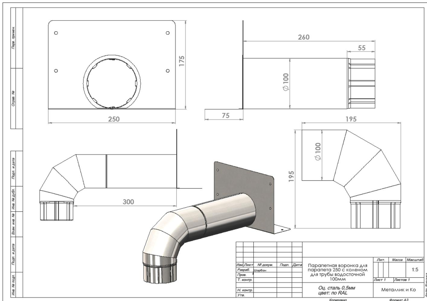
В данной конфигурации выпуск трубы парапетной воронки наружу составляет 10мм (для упрощения стыковки с коленом), после сборки расчетный размер от стены до трубы составляет 50мм.
