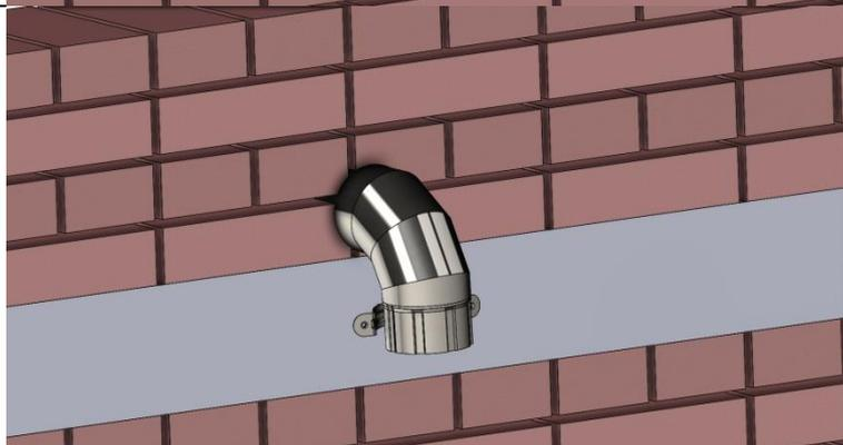
5. Присоединить трубу водосточную, зафиксировать "крепежом трубы с саморезом".
