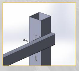
**2.Кронштейн соединительный для лаг на столб –** предназначен для соединения профильных труб 40х20 со столбами 60х60 снаружи.
