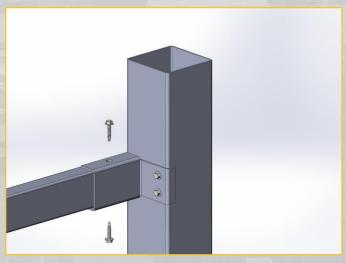
**5.Соединитель внутренний для лаг** — предназначен для соединения профильных труб 40x20 между собой, вставляется внутрь труб.
