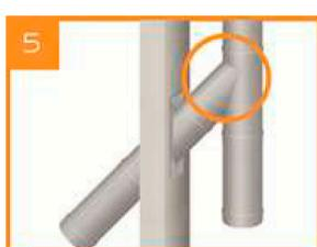
Дымовые каналы выполняются вертикальными. При необходимости допускается выполнять не более двух отклонений от вертикали, с относом не более 1 м, чтобы обеспечить удобство и эффективность чистки канала через оголовок. При наличии прочистных люков в непосредственной близости от изгиба канала допускается увеличивать относ – до 1,7 м.
