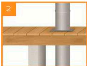
Моно труба может использоваться в помещении вплоть до прохождения межэтажного или кровельного перекрытия из горючих материалов. При прохождении вышеуказанных перекрытий и при монтаже дымохода снаружи помещения используются сэндвич трубы. При прохождении через перекрытия для обеспечения пожарной безопасности, необходимо использовать потолочно-проходной узел (ППУ). Дымовой канал, проходящий вблизи строительных конструкций из горючих материалов, не должен нагревать их выше 50°C
