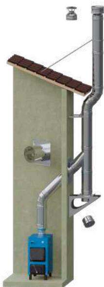
Для котла/печи вдоль наружной стены
