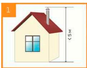
Общая высота дымового канала от колосника теплогенерирующего аппарата до устья трубы должна быть, как правило, не менее 5 м, что обеспечивает необходимое разрежение и создает тягу:
