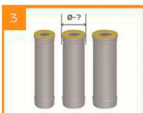
Диаметр дымового канала и, соответственно, изделий печных должен определяться исходя из требований ГОСТ 9817-95, согласно которым дымовой канал должен иметь площадь сечения не менее 8 см<sup>2</sup> на каждый киловатт мощности аппарата (печи, камина и др.).
