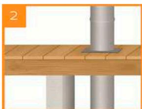
Моно труба может использоваться в помещении вплоть до прохождения межэтажного или кровельного перекрытия из горючих материалов. При прохождении вышеуказанных перекрытий и при монтаже дымохода снаружи помещения используются сэндвич трубы. При прохождении через перекрытия для обеспечения пожарной безопасности, необходимо использовать потолочно-проходной узел (ППУ). Дымовой канал, проходящий вблизи строительных конструкций из горючих материалов, не должен нагревать их выше 50°C
