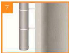
Места стыков труб и других элементов (отводов, тройников и т.п.) скрепляются хомутами и должны находиться вне потолочных перекрытий. На каждые 2 м дымохода необходимо устанавливать хомут настенный, а каждый тройник должен иметь опорный кронштейн.
