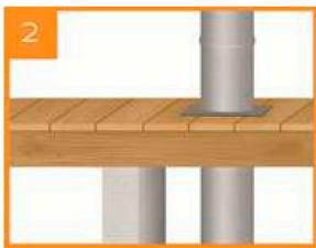
Монотруба может использоваться в помещение вплоть до прохождения межэтажного или кровельного перекрытия из горючих материалов. При прохождении вышеуказанных перекрытий и при монтаже дымохода снаружи помещения используются сэндвич трубы. При прохождении через перекрытия для обеспечения пожарной безопасности, необходимо использовать потолочно-проходной узел (ППУ). Дымовой канал, проходящий вблизи строительных конструкций из горючих материалов, не должен нагревать их выше 50°C
