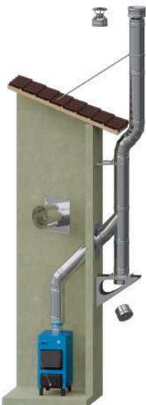
Для котла/печи вдоль наружной стены
