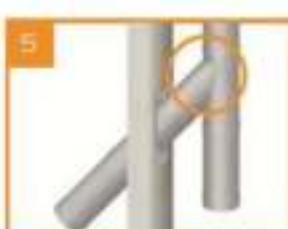
Дымовые каналы выполняются вертикальными. При необходимости допускается выполнять не более двух отклонений от вертикали, с отсчетом не более 1 м, чтобы обеспечить удобство и эффективность чистки канала через оголовок. При наличии прочистных люков в непосредственной близости от изгиба канала допускается увеличивать отсчет – до 1,7 м.
