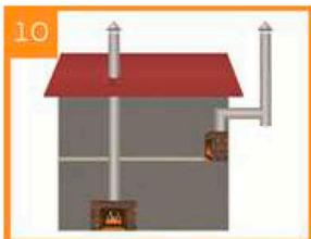
Для каждого теплогенерирующего аппарата следует устраивать собственный дымовой канал.
