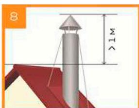
Крепление элементов систем дымоходов к строительным конструкциям должно осуществляться с помощью консолей (кронштейнов настенных) и опорных площадок не реже, чем через каждые 5 метров. Крепление соединительных труб должно исключать возможность прогиба.
