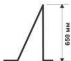
Опора треугольная - 3 шт. толщина - 4 мм.
